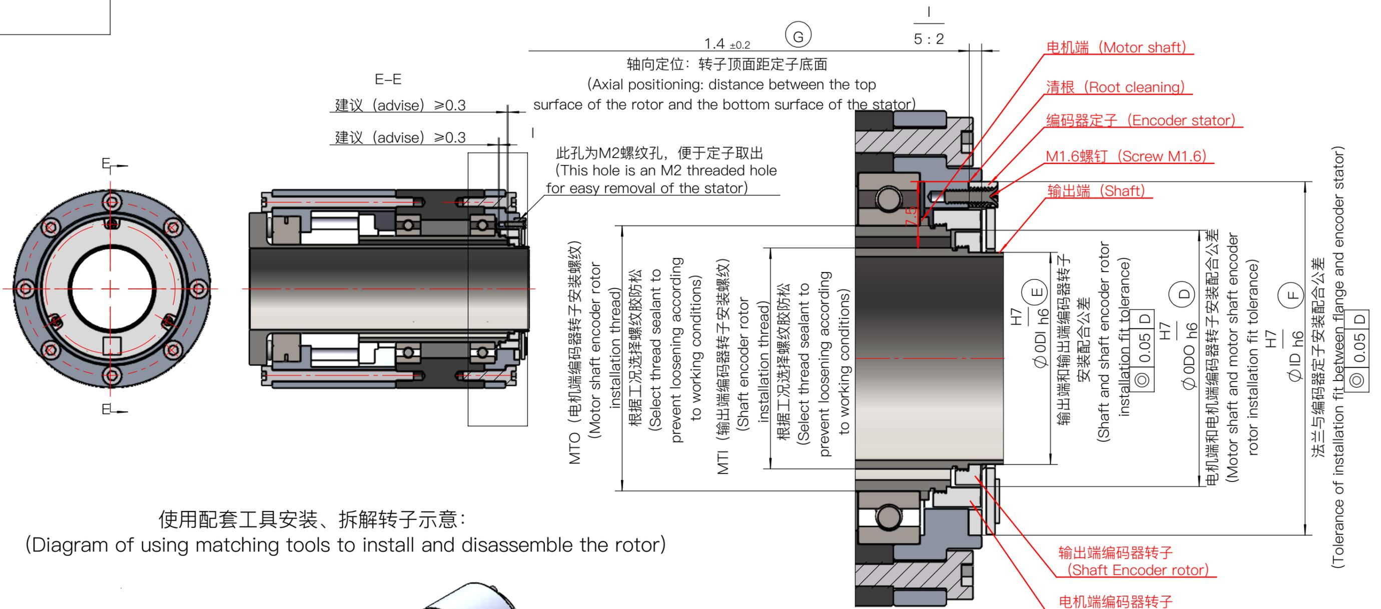
使用配套工具安装、拆解转子示意：
