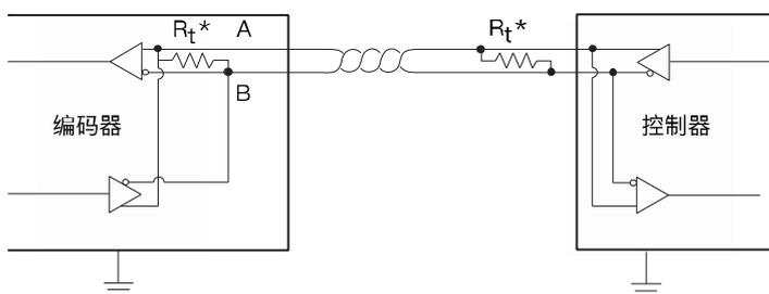
该接口为二线制，其主要是差分的 A、B 相，两根线的终端都需要来并接终端电阻，编码器端的终端电阻已经集成进了编码器内部，用户需在控制器侧 A、B 接终端电阻或其它阻抗匹配方案。
