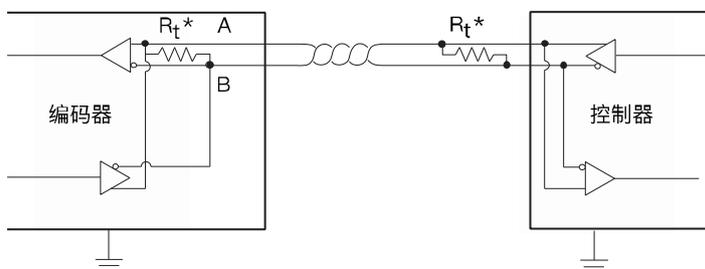
该接口为二线制，其主要是差分的 A、B 相，两根线的终端都需要来并接终端电阻，编码器端的终端电阻已经集成进了编码器内部，用户需在控制器侧端接终端电阻或其它阻抗匹配方案。
