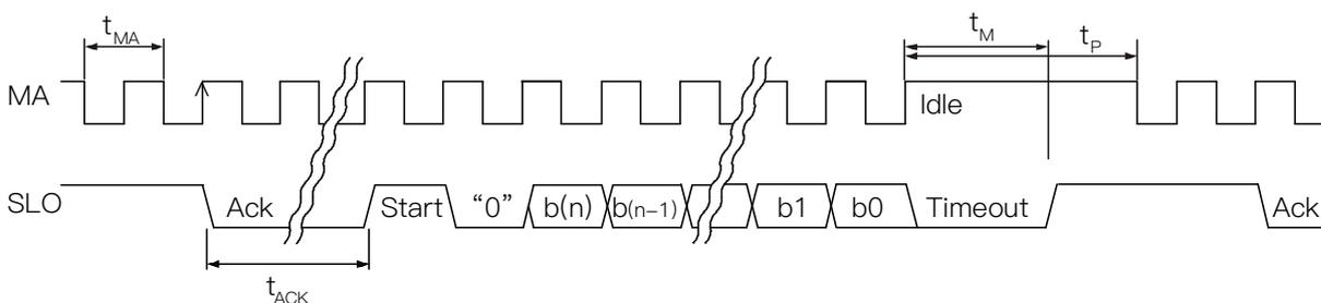
该协议使用 MA 来同步获取时钟序列，MA 线空闲时为高电平，当第一个下降沿到来时，系统则会锁存当前的数据，通信将于第一个下降沿开始，编码器将会于第二个 MA 上升沿时配置 SLO 为低电平，从“0”后 MSB 开始于每一个 MA 的上升沿写入数据至 SLO 线，而在控制器端，则会在 MA 的下降沿来读取 SLO 线上的数据，往复至到 LSB 被控制器读取到。
