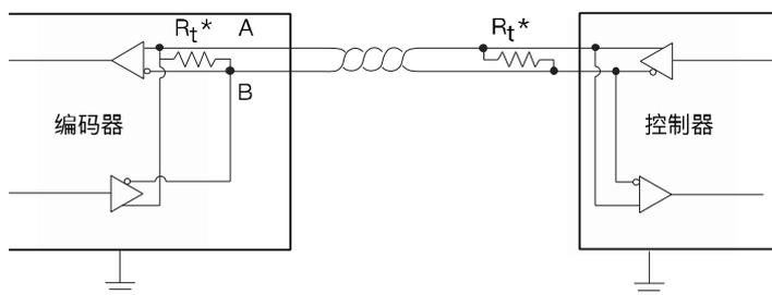
该接口为二线制，其主要是差分的 A、B 相，两根线的终端都需要来并接终端电阻，编码器端的终端电阻已经集成进了编码器内部，用户需在控制器侧端接终端电阻。
