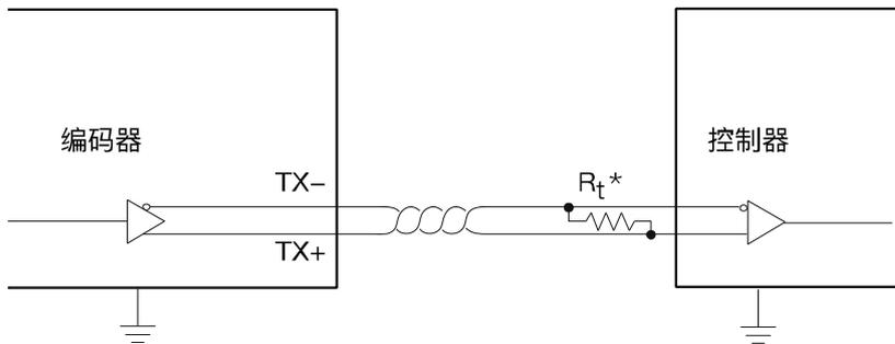
该接口为二线制，其主要是差分的 A、B 相，两根线的终端都需要来并接终端电阻，用户需在控制器侧端接终端电阻
