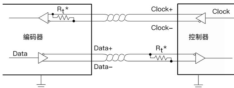
该接口使用四线制，分别为 Clock 正反相与 Data 正反相。且 Clock 的终端电阻已经被集成进了编码器内部，用户需在控制器侧 Data 端接终端电阻或其它阻抗匹配方案。
