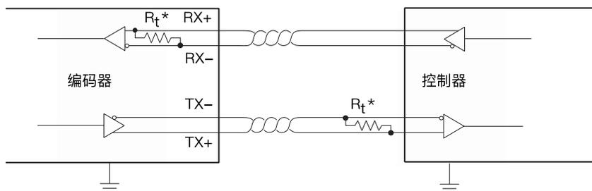
该接口使用四线制，分别为 TX 差分输出与 RX 的差分输入。且 RX 的终端电阻已经被集成进了编码器内部，用户需在控制器侧 RX 端接终端电阻或其它阻抗匹配方案。
