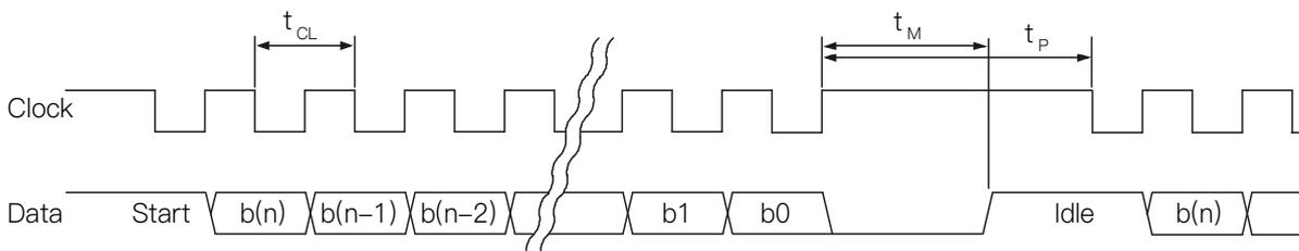
该协议使用 Clock 来同步获取时钟序列，当第一个下降沿到来时，系统则会锁存当前的数据，以及从 MSB 开始于每一个 Clock 的上升沿写入数据至 Data 线，而在控制器端，则会在 Clock 的下降沿来读取 Data 线上的数据，往复至到 LSB 被控制器读取到。
