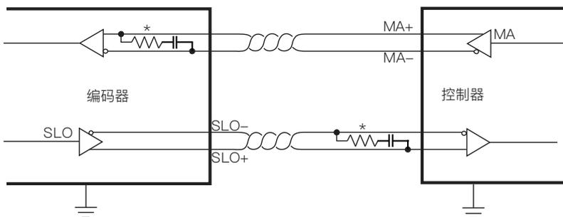
该接口使用四线制，分别为 MA 正反向与 SLO 正反向。且 MA 的终端电阻已经被集成进了编码器内部，用户需在控制器侧 SLO 端接终端电阻或其它阻抗匹配方案。
